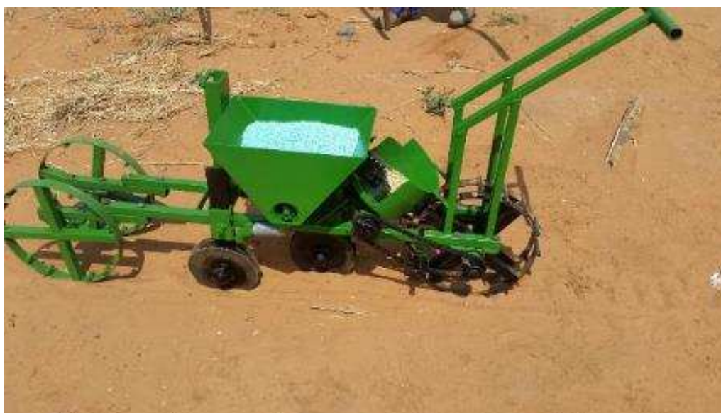
Figura 3. Exemplo de semeador/aplicador de fertilizante de tracção humana
